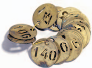
Jetons d'identification des mineurs, dont les numéros figurent aussi sur leur lampe
