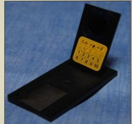
Dosimètre à radon
